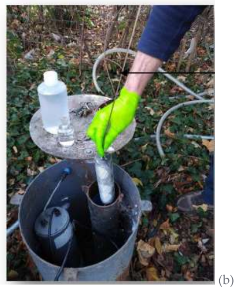
Fig. 31. Les chemcatcher, cylindres métalliques permettant de fixer les membranes (a) et mise en place dans un piézomètre (b) (© photos L.Pinasseau et Graie)
