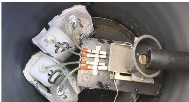
Figure 10. Système de fractionnement de l'eau dans la cuve de l'accotement filtrant.
